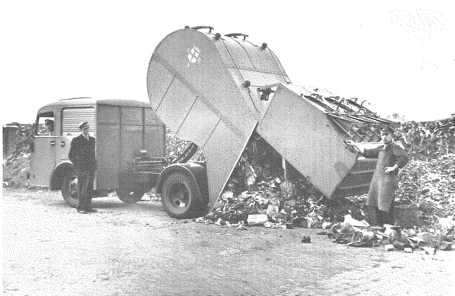
Een roltrommelwagen stort zijn lading op het terrein. Opname uit de naoorlogse periode vóór de afvoer door de VAM (ca. 1947).
