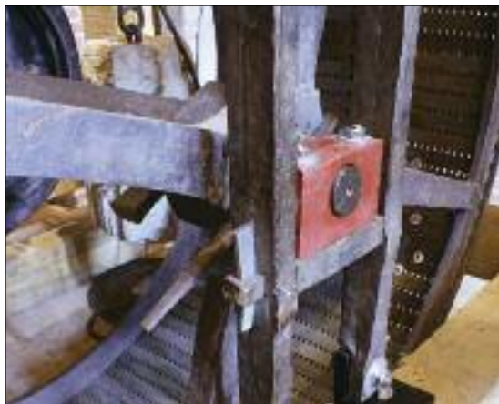
Links: Lichterbed met links drie aangesloten lichters. Boven: Museale opstelling op de luidzolder.
