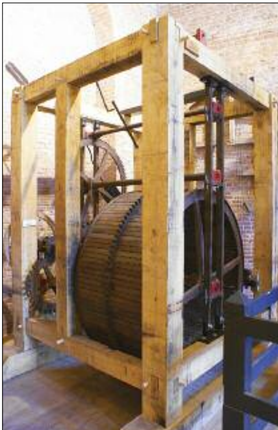
Links: De speeltrommel van Jurriaan Sprakel Boven: Sluitschijf met lichter. Rechts het opwindwiel. Rechts: Modern lagerblok; één van de spieën is een oude vijl.
