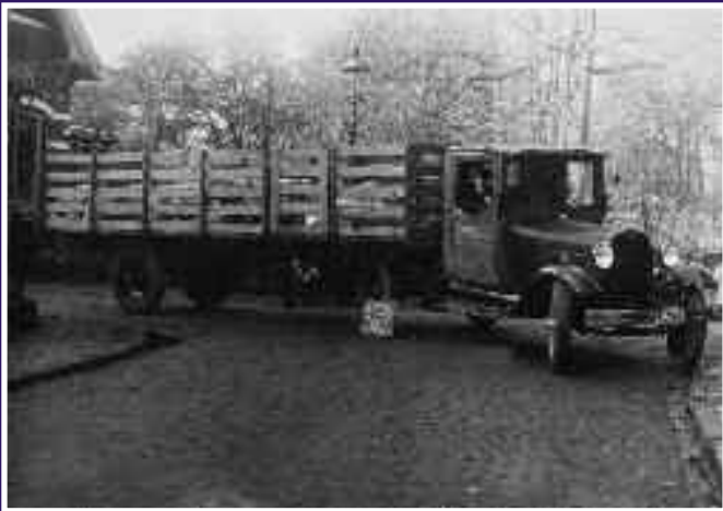
Trekker met oplegger vol varkens. Ook deze trekker is gebouwd op een A-Ford-chassis, geleverd door Van Hamersveld. 1931-1935.
