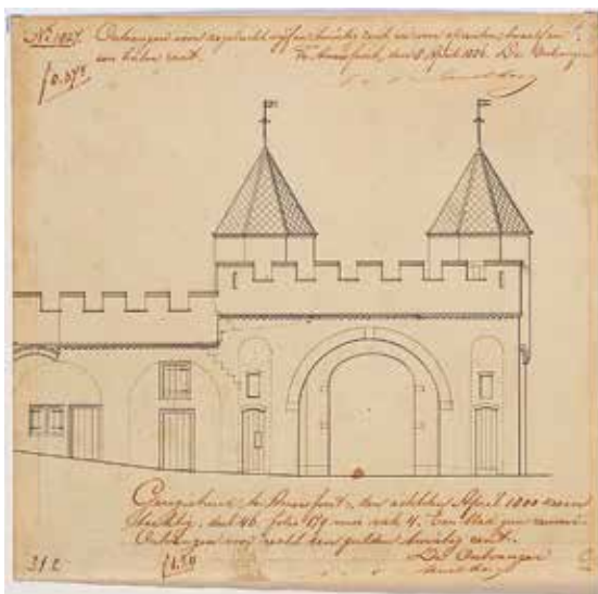
Bouwtekening voor de restauratie van de Koppelpoort.
